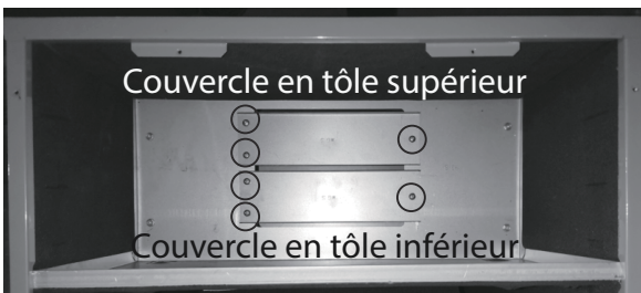
Fig. 23 – Retirez les couvercles en tôle
