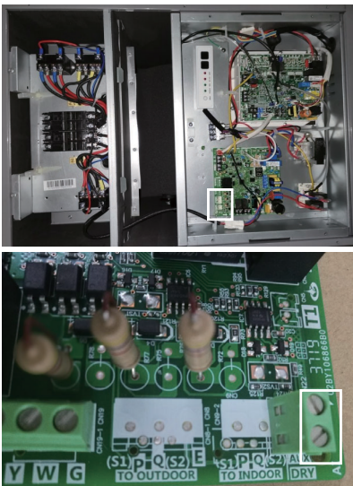
Fig. 29 – Raccordez les fils du chauffage auxiliaire
