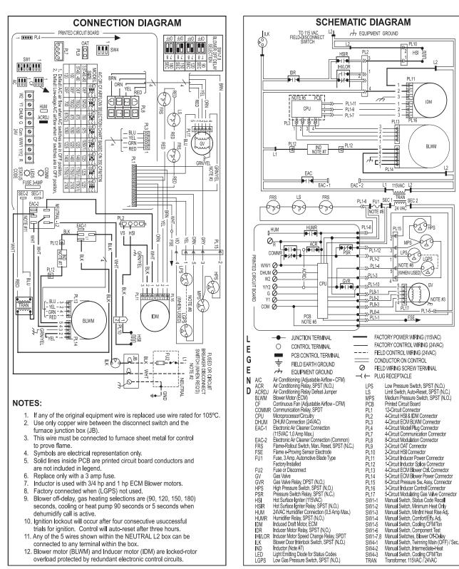
Fig. 74 – Wiring Diagram
