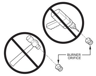
Fig. 62 - Orifice Hole
