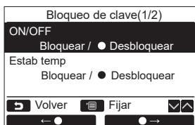
**1 Pulse el botón [↑ ↓] / [← →] para seleccionar “5. Bloqueo de clave” en la pantalla “Configuración inicial” y, a continuación, pulse el botón “Validar” [F2].**
