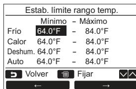
**1** Pulse el botón [ / [ ] para seleccionar “2. Estab. límite rango temp.” en la pantalla “Ahorro de energía” y, a continuación, pulse el botón “ Valida” [].
