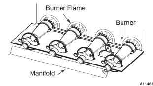
Fig. 15 - Burner Flame
